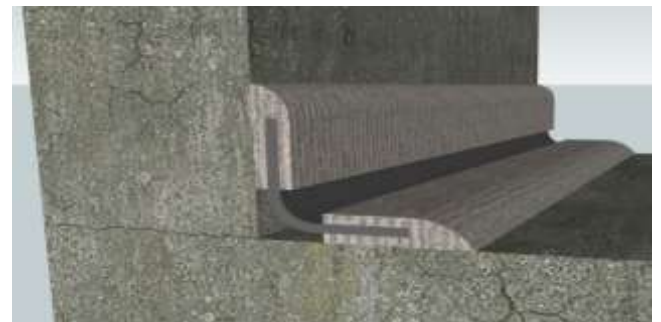
Гидроизоляция 90° конструктивного шва (например, примыкания пол-стена): Рисунок 6
